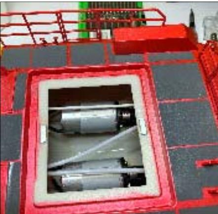
unbekannten Material. Stabil wie GFK, aber mit geringerer Wandstärke. Die Durchführungen für den Jetantrieb und die Ansteuerung waren bereits gebohrt, auch Verstärkungsleisten bei den Decksöffnungen sind bereits eingeklebt. Der Rumpf ist innen extrem glatt, die Außenseite ist leicht angeraut, schon fast lackierfähig.
