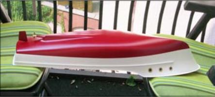
Also Werkzeug gebastelt mit Kröpfungen der unmöglichsten Art, die Bullaugen von außen eingesetzt und angedrückt und mit meinem Spezialwerkzeug von innen verklebt. Gut, dass der Kleber nach dem Aushärten durchsichtig ist. Beim Deck selbst waren die Hilfsspannten leider bereits ausgeschnitten, sodass die Decksseiten vom Rumpf an der mittleren Arbeitsöffnung abgestützt werden mussten. Bei der hinteren Öffnung musste noch ein Querspant eingezogen werden. Nun ist das Deck stabil.
