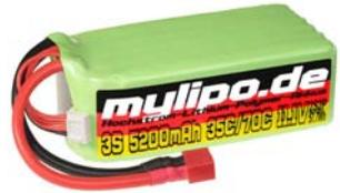
Im Falle eines Modell-Absturzes oder sonstiger Beschädigung führen Sie die Lipo-Akkus bitte der Entsorgung zu. Dazu entladen Sie den Akku mit einem geringen Strom (<math><0,1C</math>) auf 3,0V, schützen die Kabel vor Kurzschluss und bringen Sie sie in eine Batteriesammelbox oder zum Recyclinghof. Lipo-Akkus gehören nicht in den Hausmüll.
