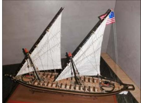
Die US-Version der Boote war 29 m lang und 4,70 m breit. Bei einem Tiefgang von 1,10 m trug das Boot im Bug ein 12-Pfünder Langrohrgeschütz und im Heck eine 12-Pfünder Carronade. Beide auf Drehgestellen montiert und jeweils um 90 Grad auf jede Seite drehbar.
