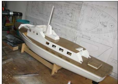
Nach rund acht Wochen Ausbesserungsarbeiten und Ersatzteilbeschaffung war es dann soweit. Alle zu kurzen Teile, auch beim Aufbau, waren angesetzt, gespachtelt und verschliffen. Beim Aufbaus ging relativ leicht, aber die Kleinteile und der Rahmen für den Aufbau hatten es in sich. Auch die Bullaugen im Rumpf Vorderteil, über dem das eingeklebte Deck war, waren schon eine Herausforderung. Von außen einkleben? Nein, da könnte der Lack beschädigt werden und obs dann auch dicht ist - na ja.
