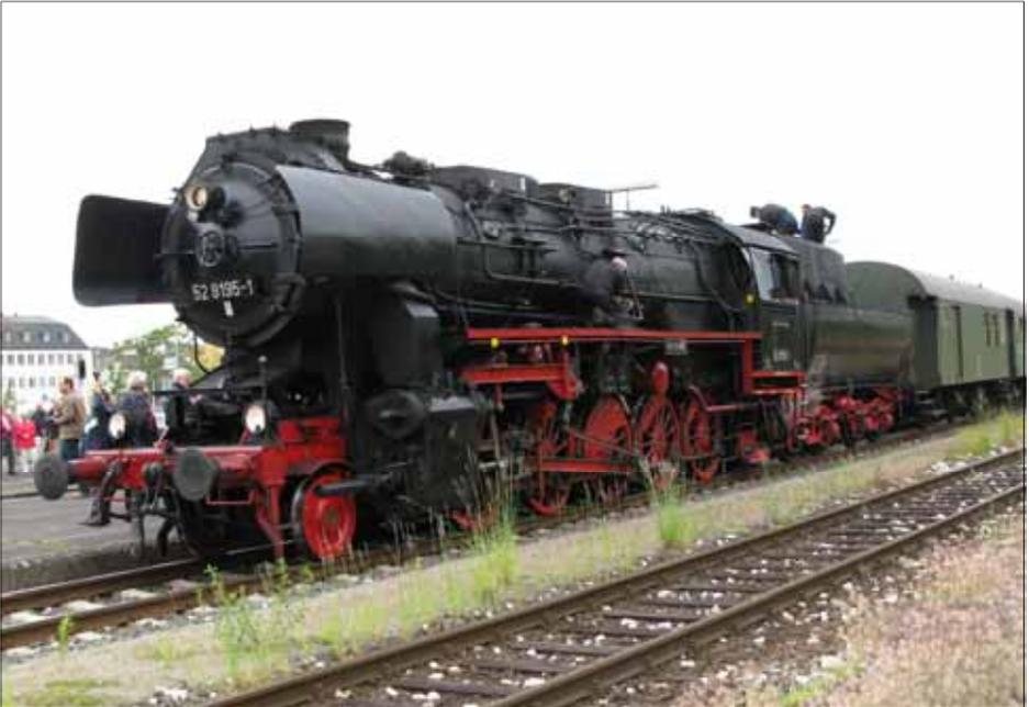
Die Baureihe 52 8195 ist eine von weit über 3000 in verschiedenen Lokschmieden gebaute Kriegslokomotive, die während des 2. Weltkriegs unter diversen Vereinfachungen aus der BR 50 mit der Achsfolge 1'É'h2 abgeleitet und in BR 52 umbenannt wurde.
